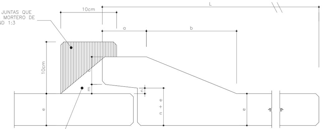
MORTERO COMPUESTO DE 1 PARTE DE CEMENTO POR 3 DE ARENA (EN VOLUMEN)
