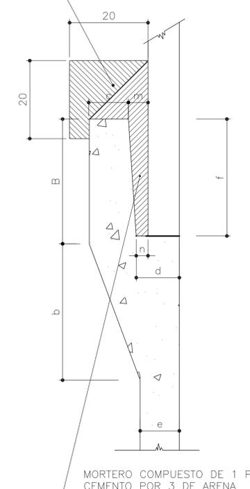
MORTERO COMPUESTO DE 1 PARTE DE CEMENTO POR 3 DE ARENA
