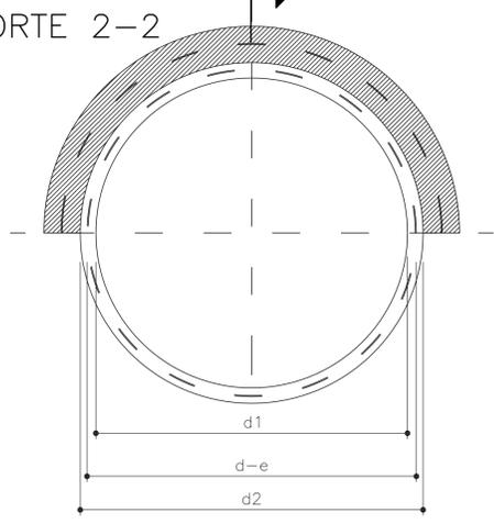
ARMADURAS LONGITUDINALES Y HELICOIDALES DE UN CAÑO DE H\* SIN PRECOMPRESION
